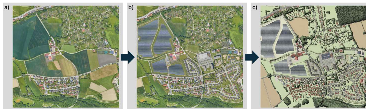
Abb. 5: Ergebnisse des kombinierten, iterativen Workflows zur KI-gestützten Stadtteilerweiterung im GIS. a) Referenzluftbild als Ausgangszustand. b) Synthetisches Luftbild nach schrittweiser Ergänzung neuer Nutzungen innerhalb überlappender
