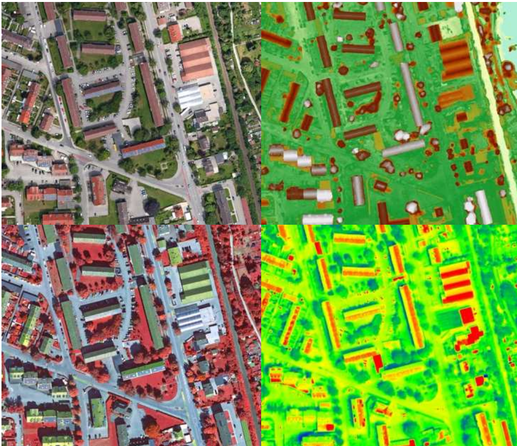
Abb. 1: Aus einem Bildflug können mehrere Luftbildprodukte erzeugt werden: RGB-True-Orthofoto (links oben), Oberflächenmodell (rechts oben), Multispektralaufnahme (links unten), Thermalaufnahme (rechts unten) (RealityMaps, 2024)
