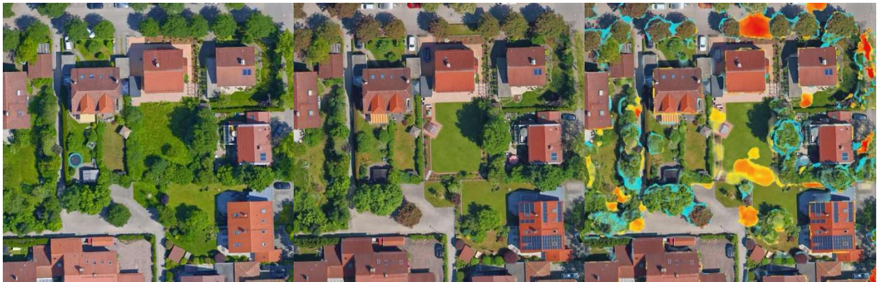
Abb. 6: Durch die vergleichende Auswertung von multitemporalen Luftbildern können zwischenzeitliche Veränderungen beobachtet und festgehalten werden: hier ein Ausschnitt von 2020, 2023 und das Ergebnis der Differenzanalyse).
