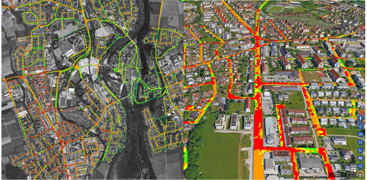
Abb. 3: Erkannter oberirdischer Verkehr und dessen Verteilung auf die Straßenverkehrsflächen als Heatmap (links), Auswertung von Thermalinformationen der Straßenverkehrsflächen (rechts). Grün: kühl – rot: heiß (3D RealityMaps 2024)
