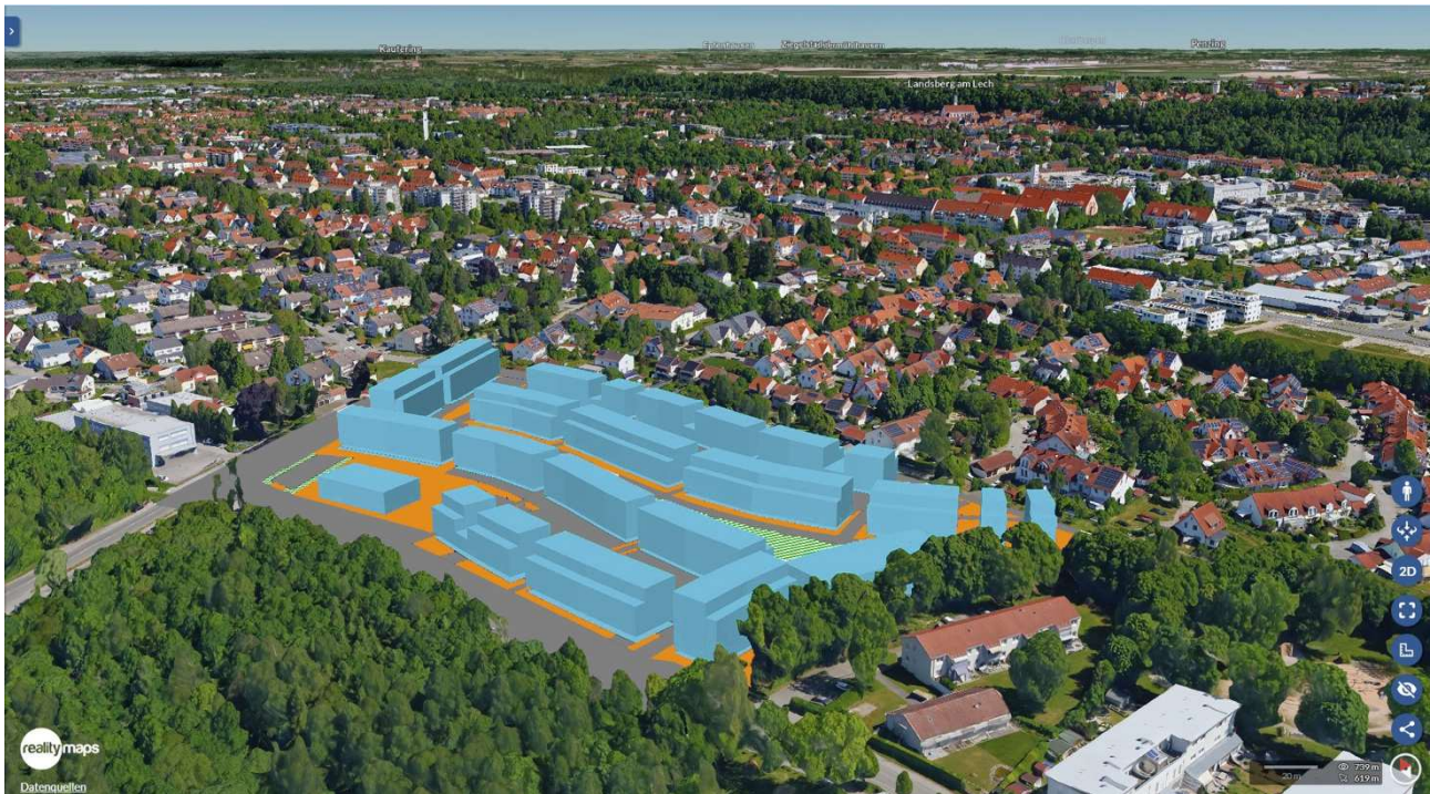
Abb. 7: Import eines Bebauungsplans im XPlan-GML-Format in der Planungsebene (RealityMaps 2024)
